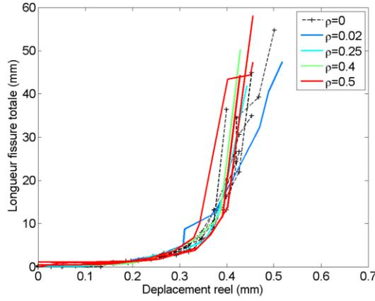
Fig. 10. Description de la longueur de fissure en fonction du déplacement imposé à partir de plusieurs essais de traction sur plaque rainurée  $[0_2/90_2]_S$  de carbone/époxy T700GC/M21 avec différents états d'endommagement.
