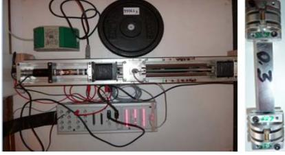
Figure 1 : Le robot expérimental et l'accouplement flexible
