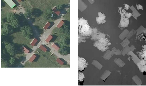
FIGURE 2: Comparaison d'une image aérienne (source IGN) et du MNE obtenu à partir de données Lidar mises en géométrie commune à l'aide des mesures brutes délivrées par le système de navigation. L'inconsistance de ces mesures produits des bâtiments fantômes autour du carrefour.
