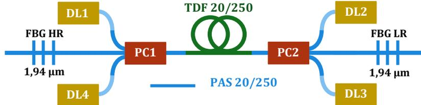
Figure 2 : Représentation schématique du montage expérimental de la source laser de pompe monolithique à fibre dopée  $Tm^{3+}$  en oscillateur unique. Les fibres passives et actives sont représentées par des traits bleus et verts, respectivement.
