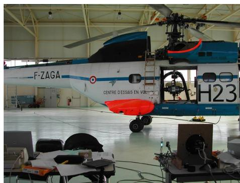
FIG. 2.1 – En haut à gauche, notre spectro-imageur installé sur la boule gyro-stabilisée, au-dessus de la trappe du Puma. Du spectro-imageur, on ne voit que le capot cylindrique noir de la caméra, sur la droite du fourreau gris de *Timbre-Poste*. À droite, une vue d'ensemble de l'hélicoptère du CEV, pris au décollage sur la figure du bas.
